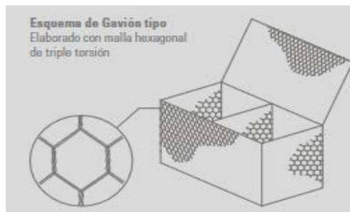
Este tipo de gaviones se los puede realizar con las dimensiones que se observan en la tabla de la parte inferior, pero en este caso se utilizaran los gaviones de 2x1x1 el cual cuenta con un volumen de 2m<sup>3</sup> por gavión que a su vez es el más utilizado en el campo de la ingeniería, la ubicación de los gaviones estarán señaladas en los planos y deberán colocarse posterior a la aprobación del Fiscalizador.
