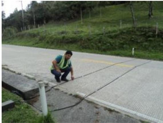
Figura 6. Instalación del equipo MetroCount.
