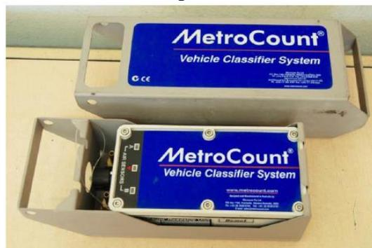
Figura 8. Contador utilizado
