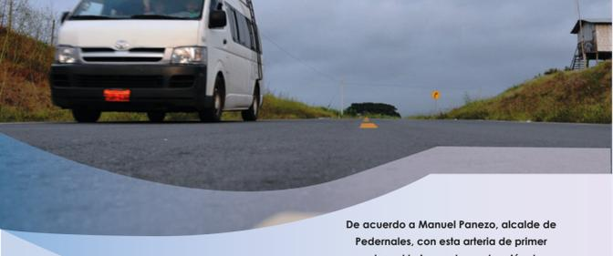
La vía de 9,70 metros de ancho de calzada, cuenta con señalización horizontal y vertical como balizas, fajas reflectivas en el eje y los laterales, y bandas de alerta transversales -BTA-, en los tramos poblados.
