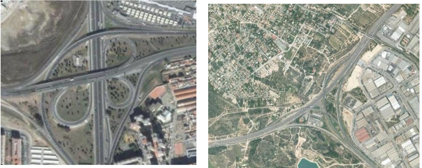
Figura 2A. 204–21 Intercambiadores de Trafico de 3 ramales. (Direccional)
