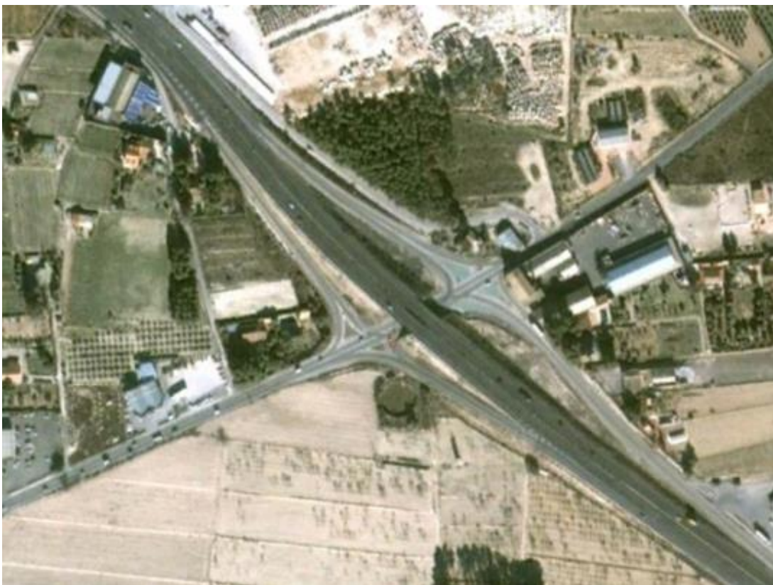
Figura 2A. 204-22 Intercambiadores de Tráfico de 4 ramales. (Diamante)
