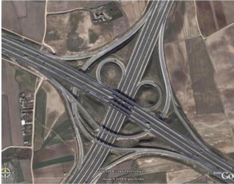
Variante tipo media turbina
