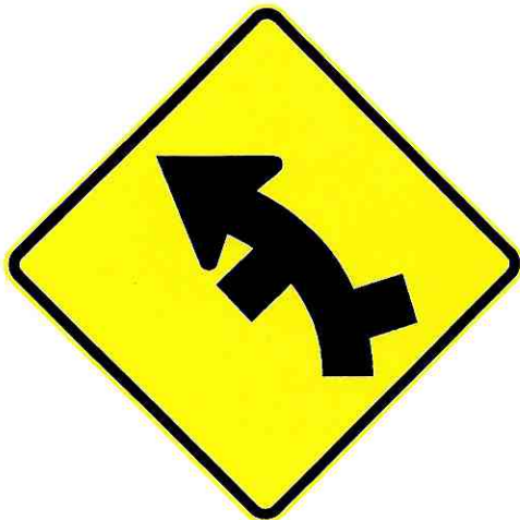
P2 - 12/ EMPALME LATERAL SUCESIVO EN CURVA IZQ.
