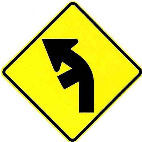
P2 - 11/ EMPALME LATERAL INTERNO EN CURVA IZQ.
