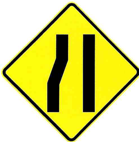
P4 - 5I ANGOSTAMIENTO DE LA VÍA IZQ.
