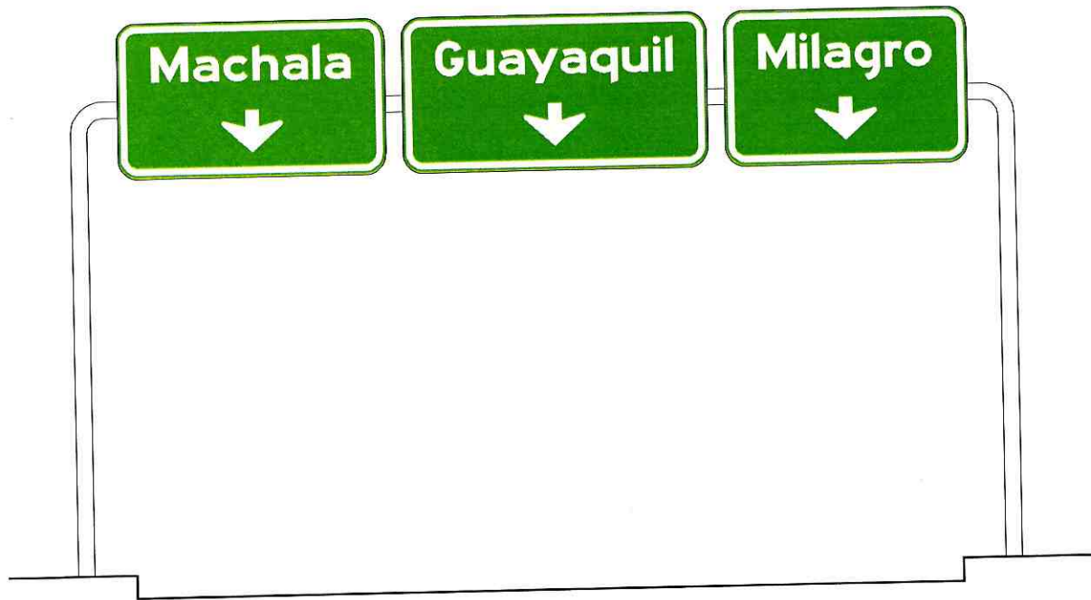
FIGURA 8.7 Ensamblaje típico de señales aéreas con asignación de carril (Ver parte 1)
