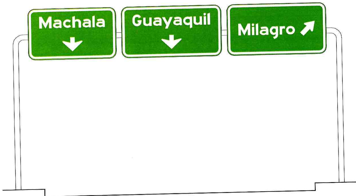
FIGURA 8.8 Ensamblaje típico de señales aéreas con asignación de carril con carril de salida (Ver parte 1)
