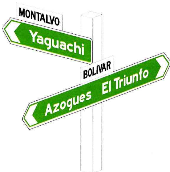
Disposición típica de señales de dirección de intersección con nombres de calles Ver figura 8.5 (Parte 1)
