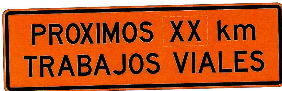
T1 - 6 PRÓXIMOS km TRABAJOS EN LA VÍA
