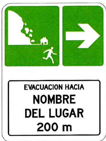
SGR4 - d1 EVACUACIÓN DESLIZAMIENTOS Y DERRUMBES HACIA LA DER.
