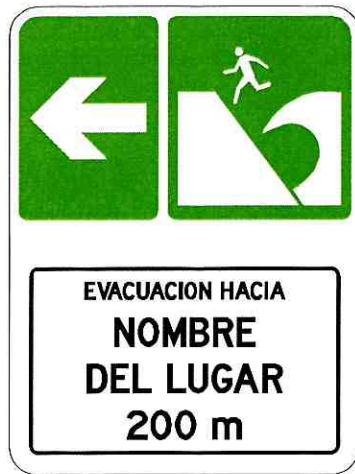
SGR4 - t2 EVACUACIÓN DE TSUNAMI EN ALTURA HACIA LA IZQ.
