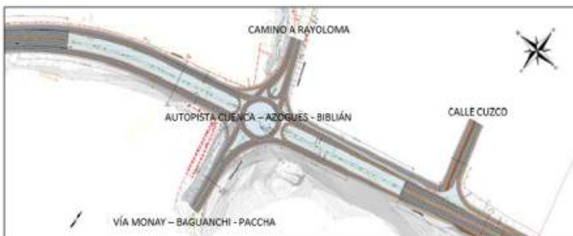
FIGURA VI-175: Diseño en planta del distribuidor Monay – IESS, vista de vías elevadas. Elaboración: Equipo consultor, 2019
