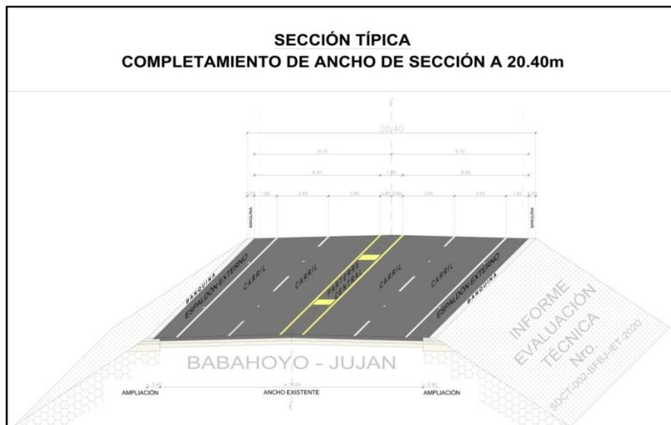
Gráfico 26 Sección Típica, completamiento de ancho de sección
